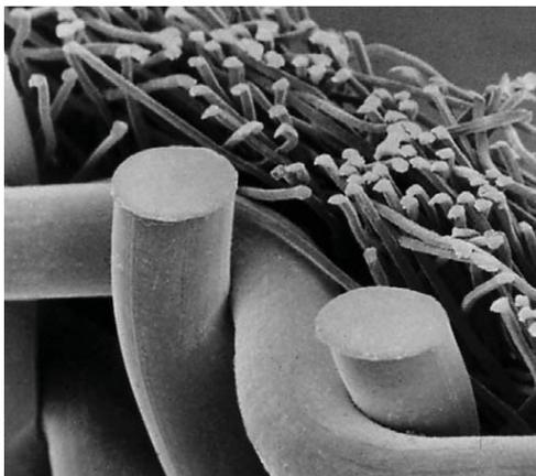
La sua tipologia di costruzione consente a parità di superficie e differenza di pressione di trattenere un quantitativo di SST molto superiore rispetto al tessuto tradizionale monofilo, inoltre le fibre risultano molto più stabili rispetto al tessuto monofilo quando vengono sottoposte a delta P.
