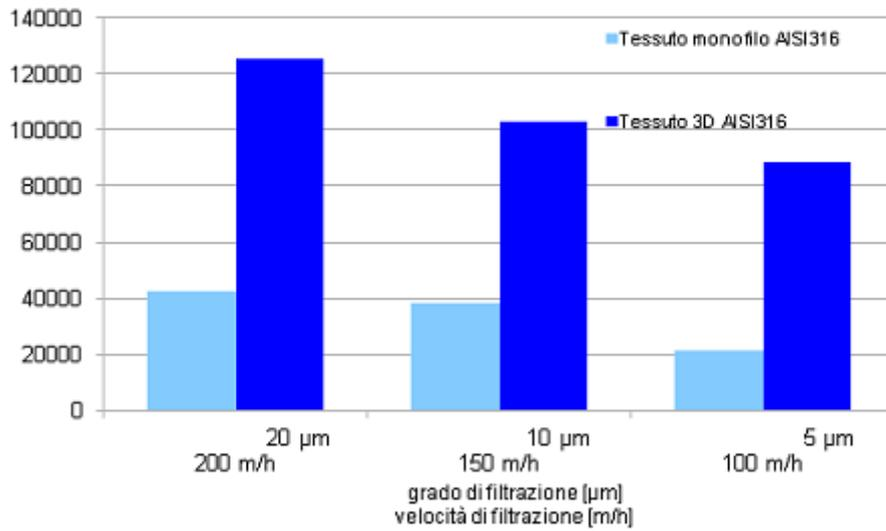
Di seguito riportiamo il grafico delle efficienze di filtrazione per tessuti 3D e diversi gradi di filtrazione alle velocità di riferimento.
